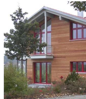
Abb.: Der kleinkronige Hausbaum wurde ostseitig so positioniert, dass die Wohnräume nicht übermäßig verschattet werden.
